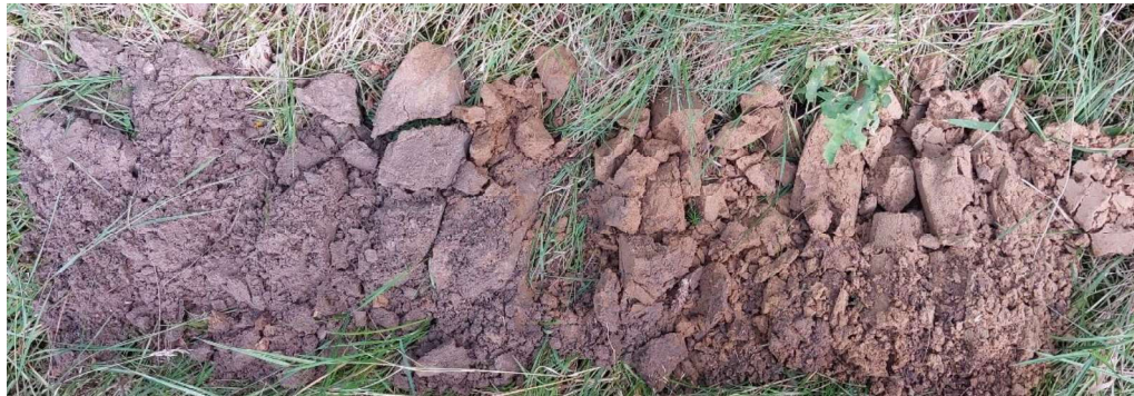
Afbeelding 3. Boorkern van boring 2, met een restant van een BC-overgang (maaiveld links, natuurlijke ondergrond rechts).
