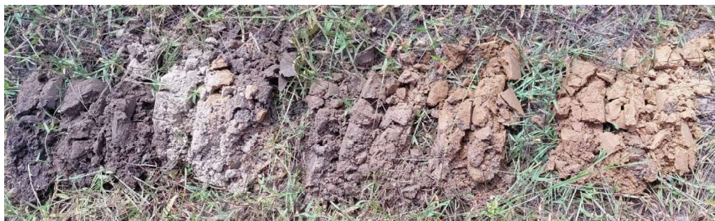
Afbeelding 4. Boorkern van boring 3, met enkele ophoogpakketten (maaiveld links, natuurlijke ondergrond rechts).
