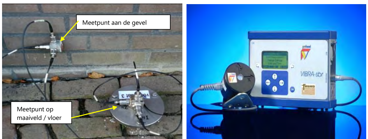
Figuur 2-12: Meetpunten 5 MP piezo meetsysteem (links) en standalone meetsysteem, Vibra met opnemer (rechts)
