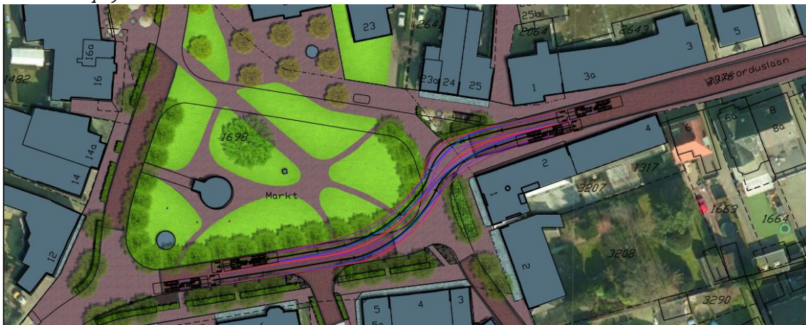
Model sleeplijnen vrachtauto met afvlakken bochten
