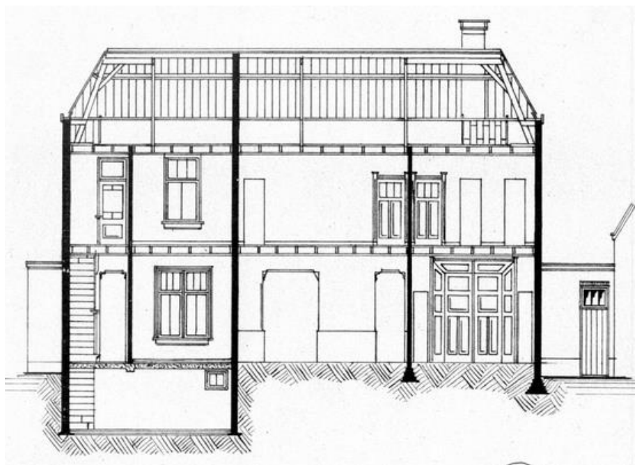
De balklagen op een dwarsdoorsnede uit 1925.
