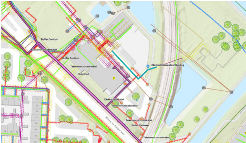
Afb. Overzicht aanwezige kabels & leidingen
