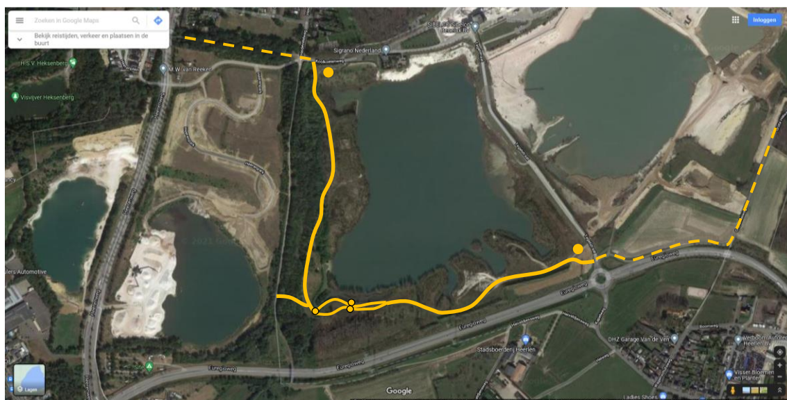
Figuur 5: Luchtfoto van het deelgebied Zuid met de te halfverharden onderhoudsweg (oranje lijn) en de aansluitende routes over bestaande wegen (onderbroken oranje lijn). De Zilverduintuin en de 'zandspin' staan met oranje stip gemarkeerd. De bruggetjes in de route zijn gemarkeerd met de kleine zwart omlijnde oranje stippen (bron luchtfoto: Google Maps).
