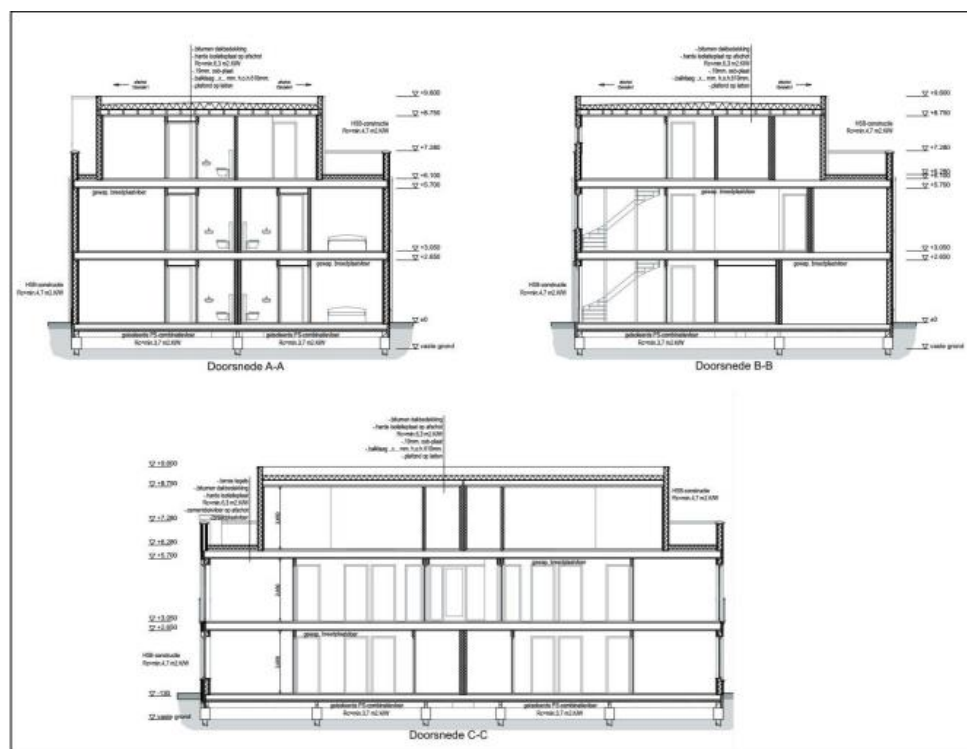
Figuur 3.3 Doorsnede appartementengebouw Julianastraat (bron: Bouwtekstuur)
