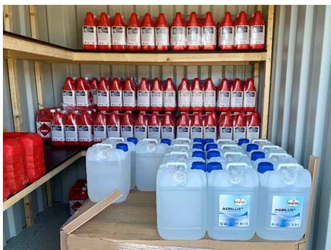
Opslag bodembedreigende stoffen zonder lekbak
