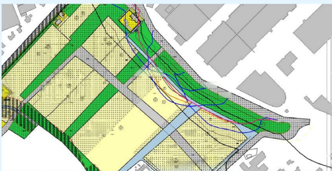
figuur 12: ligging 55 dB(A)-etmaalwaarde cumulatief (paars), 50 dB(A) per bedrijf (blauw) en 60 dB(A) maximale geluidsniveau in de nacht (oranje). Rekenhoogte 11 meter (3 bouwlagen).
