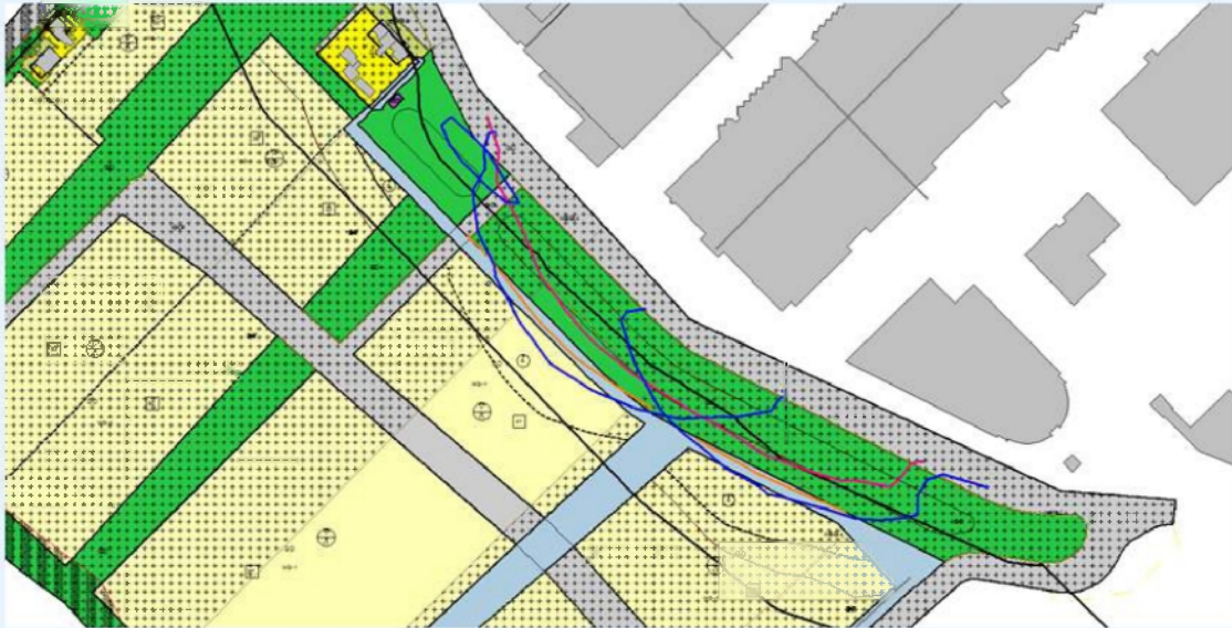
figuur 11: ligging 55 dB(A)-etmaalwaarde cumulatief (paars), 50 dB(A) per bedrijf (blauw) en 60 dB(A) maximale geluidsniveau in de nacht (oranje). Rekenhoogte 6 meter (2 bouwlagen).
