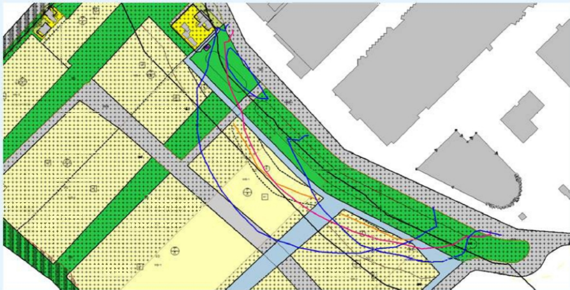
figuur 8: ligging 55 dB(A)-etmaalwaarde cumulatief (paars), 50 dB(A) per bedrijf (blauw) en 60 dB(A) maximale geluidsniveau in de nacht (oranje). Rekenhoogte 11 meter (3 bouwlagen).
