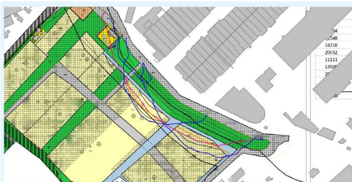
figuur 13: ligging 55 dB(A)-etmaalwaarde cumulatief (paars), 50 dB(A) per bedrijf (blauw) en 60 dB(A) maximale geluidsniveau in de nacht (oranje). Rekenhoogte 16 meter (gestapelde bouw).
