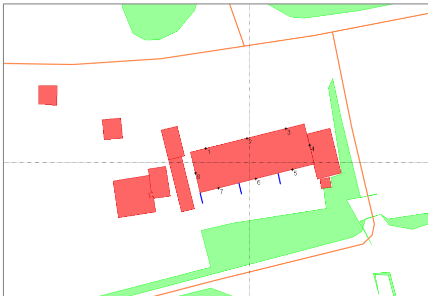
Figuur 1: Weergave rekenmodel waarbij de privacy-schermen aan de zuidgevel in blauw zijn aangegeven.
