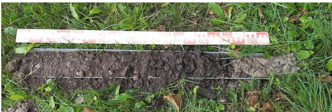
Afbeelding 13: Boring 4, met v.l.n.r. achtereenvolgens de puinrijke ophooglagen en het lichtgrijze fijne dekzand.
