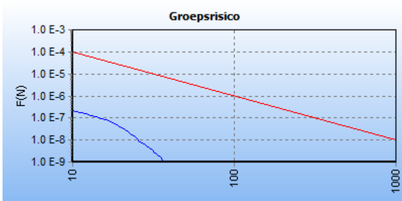
5.1 Figuur 6.1 FN curve voor 8376_leiding-N-570-20-deel-1 van N.V. Nederlandse Gasunie voor de kilometer tussen stationing 2180.00 en stationing 3180.00
