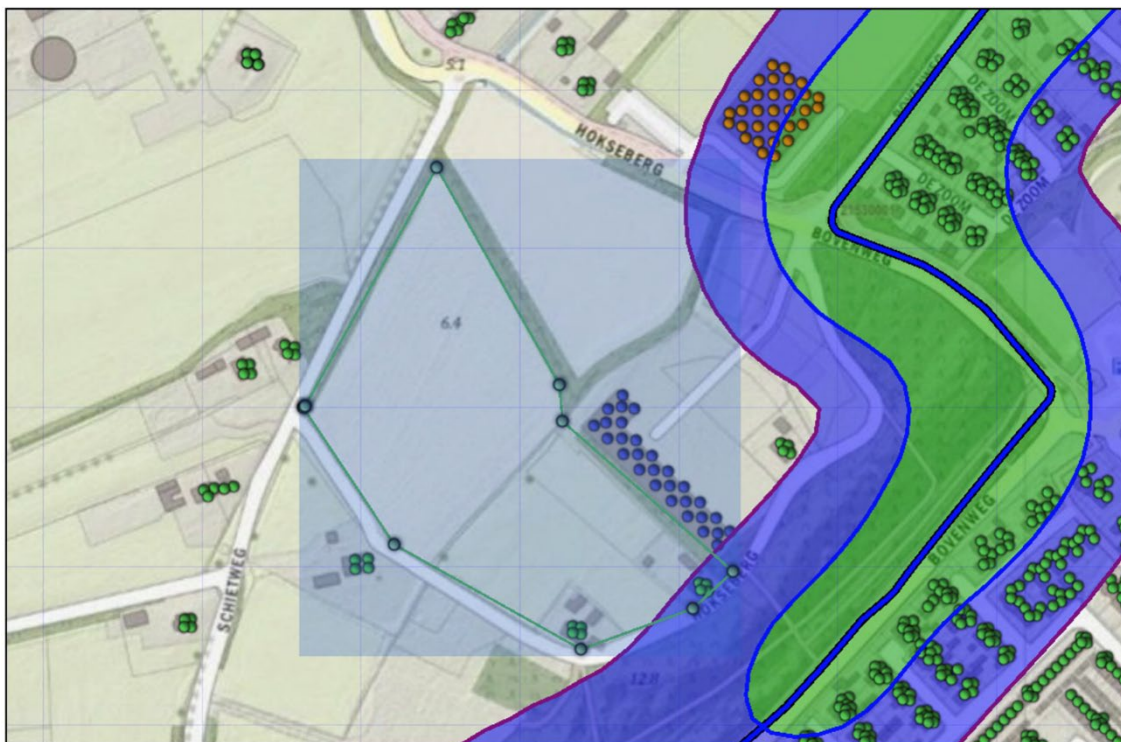
3.1 Figuur 3.1 Plaatsgebonden risico voor 8376_leiding-N-570-20-deel-1 van N.V. Nederlandse Gasunie
