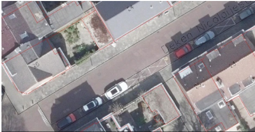
Figuur 27: voorbeeld van trottoir dat te smal is voor boomvakken i.c.m. knelpunt kabels en leidingen (Lindeveld)
