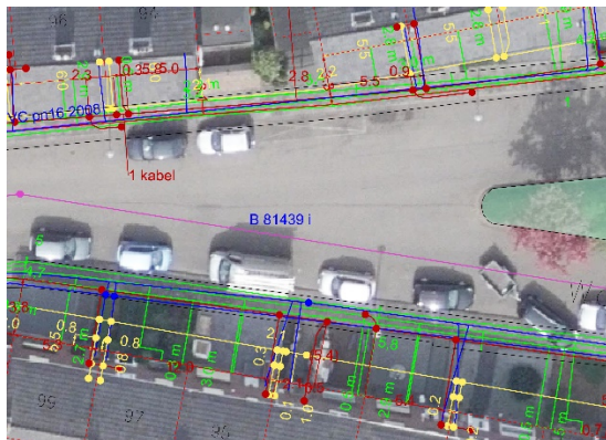
Figuur 7: terugkerende situatie in beide wijken: spanningsveld met ondergrondse infrastructuur onder de trottoirs (gas- en waterleiding).
