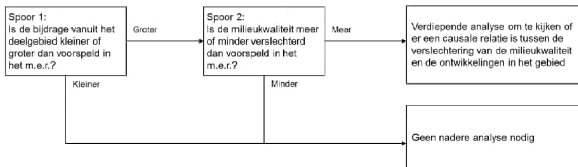
Figuur 2.2: schematische weergave systematiek monitoring
