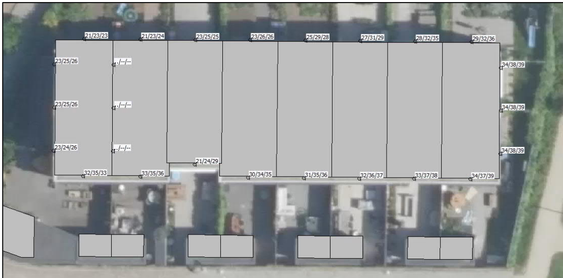
Figuur 4-4 Berekende L_{A,T} , in dB(A) in de dagperiode in 2040 door de luchtbehandelingsinstallatie (Hoogte op 1,5 / 4,5 / 7,5 m).
