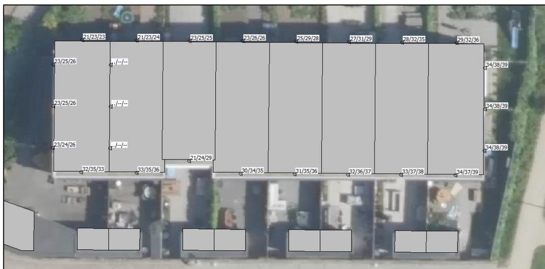
Figuur 4-2 Berekende L_{A,T} , in dB(A) in de dagperiode in 2022 door de luchtbehandelingsinstallatie (Hoogte op 1,5 / 4,5 / 7,5 m).
