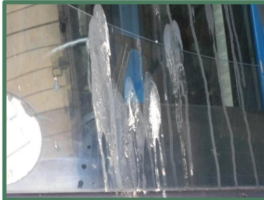
Afbeelding 33: Krijtsporen op akkerbouwmachine
