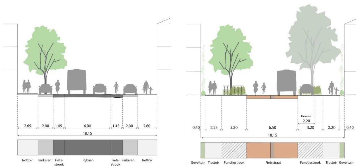
Afbeelding 3.7. Doorsnede 2 van de Willem van Noortstraat nu en in het nieuwe ontwerp.
