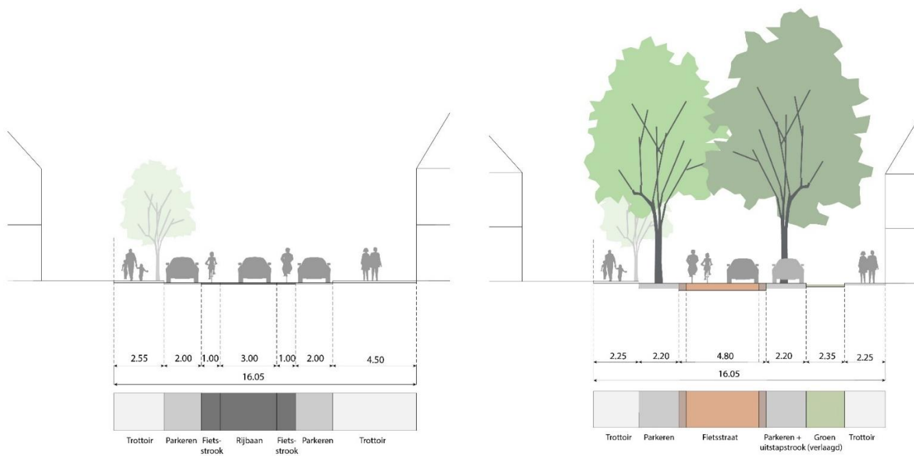
Afbeelding 3.20. Doorsnede 2 van de Pieter Nieuwlandstraat nu en in het nieuwe ontwerp.
