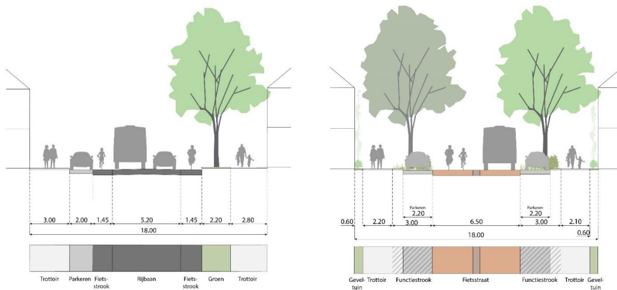
Afbeelding 3.8. Doorsnede 1 van de Antonius Matthaeslaan nu en in het nieuwe ontwerp
