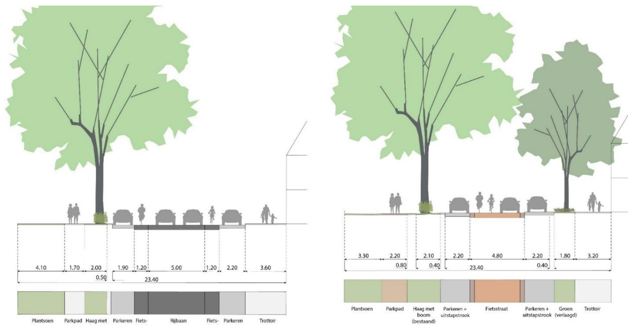
Afbeelding 3.24 Doorsnede van de Ingen Houszstraat nu en in het nieuwe ontwerp.
