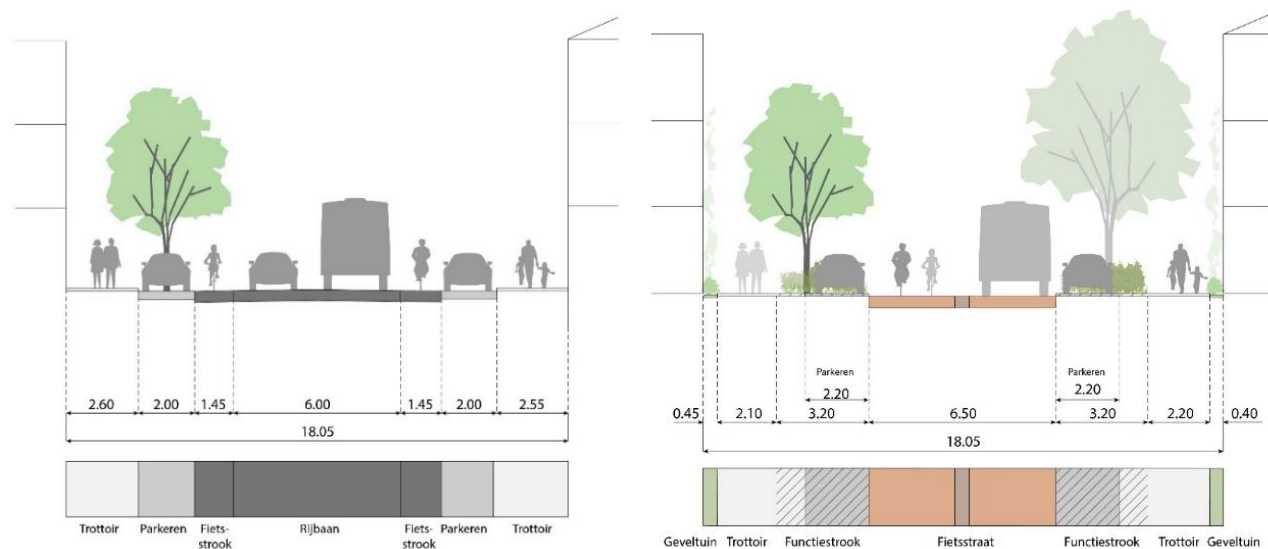
Afbeelding 3.6. Doorsnede 1 van de Willem van Noortstraat nu en in het nieuwe ontwerp
