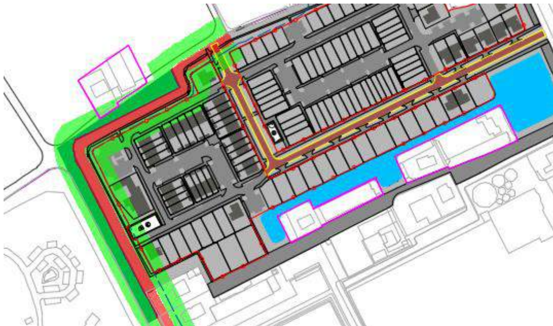
Afbeelding 4.4 Het rode gebied geeft de waterkeringszone aan, en het groene gebied is de beschermingszone zoals deze zijn aangegeven in de legger
