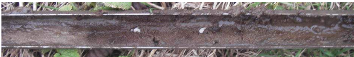
Figuur 6: Foto van boring 7 met geoxideerd, humushoudend zand.
