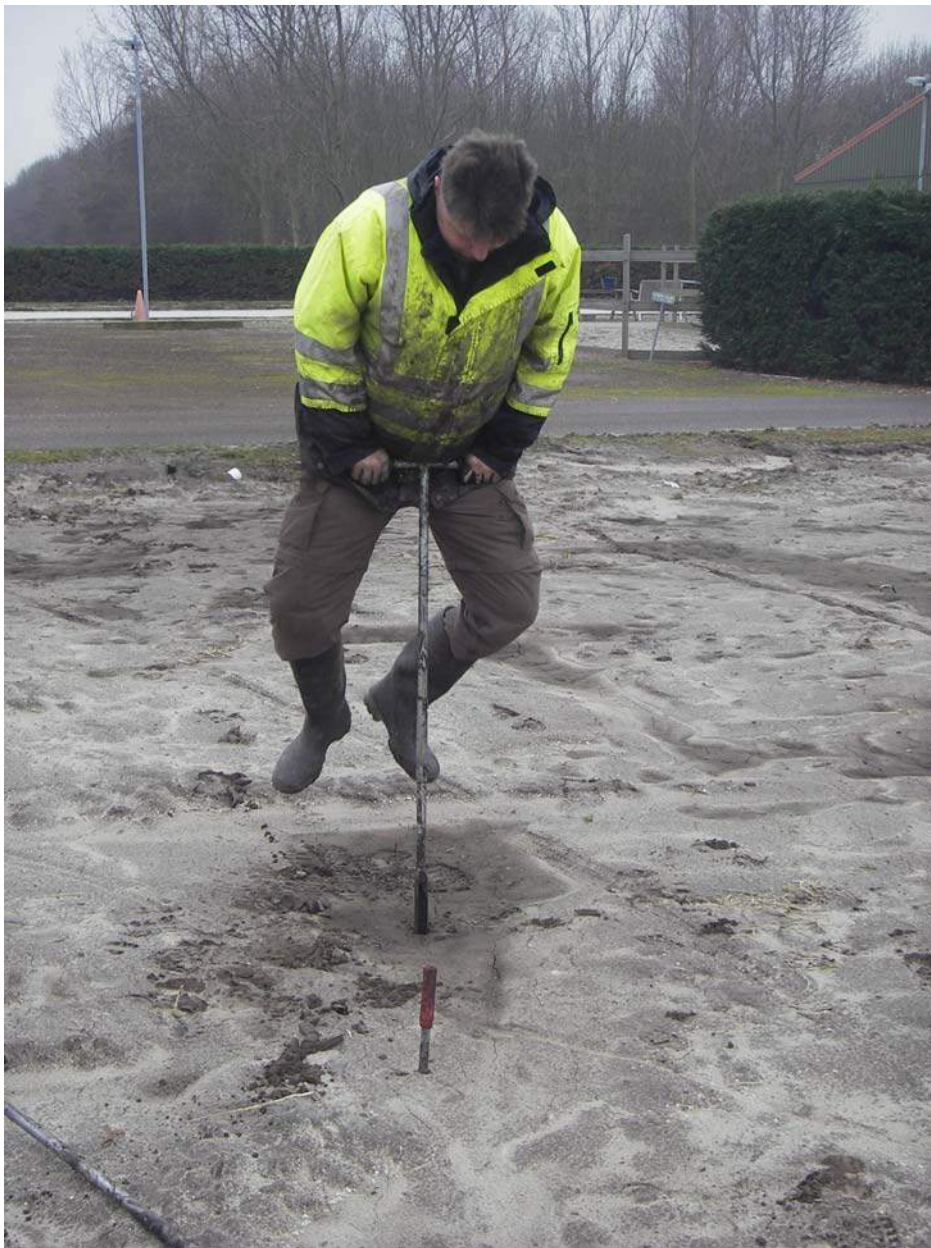
Figuur 4: Booronderzoek met behulp van een guts.
