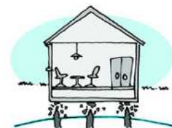
Grondwaterpeil te laag: paalrot
