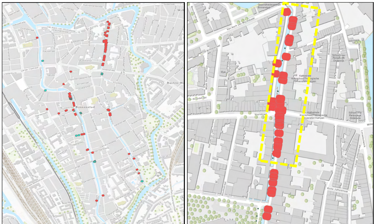
Figuur 4-2: Overzicht geïnspecteerde kelders ten opzichte van scheuren van het type II, III en IV voor het gehele Wervengebied (links) en de Plompentorengracht/Drift (rechts). De locatie van de sonderingen is hierin aangegeven met de ronde groene stippen (●).
