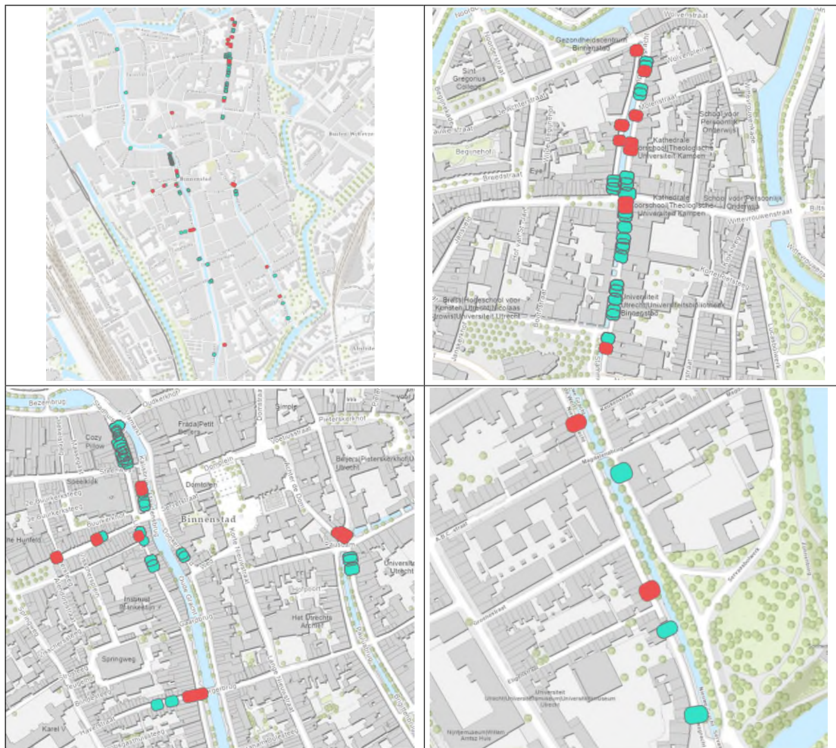
Figuur 4-12: Kelders waar type I scheuren (groep A) zijn aangetroffen per gebied.
