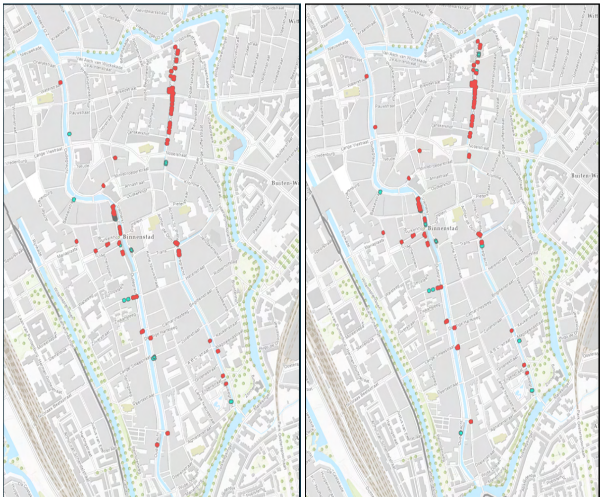
Figuur 4-1: De geïnspecteerde kelders (groen en rood) met daarin in het rood aangegeven wanneer in de kelder schade is aangetroffen. In de linker afbeelding voor de kelders waar scheurvorming is aangetroffen en rechts voor de kelders waar vocht-/vorstschade is aangetroffen.
