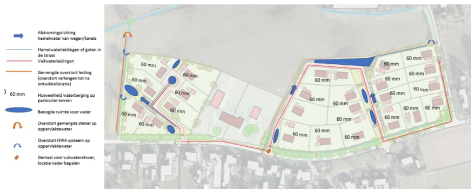
Voorstel waterberging en waterstructuren deelgebied C
