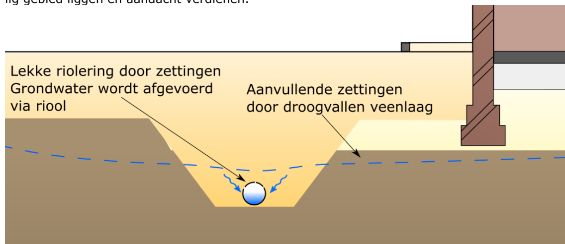
Figuur 18 Effecten van lekke riolering op grondwater en zetting
