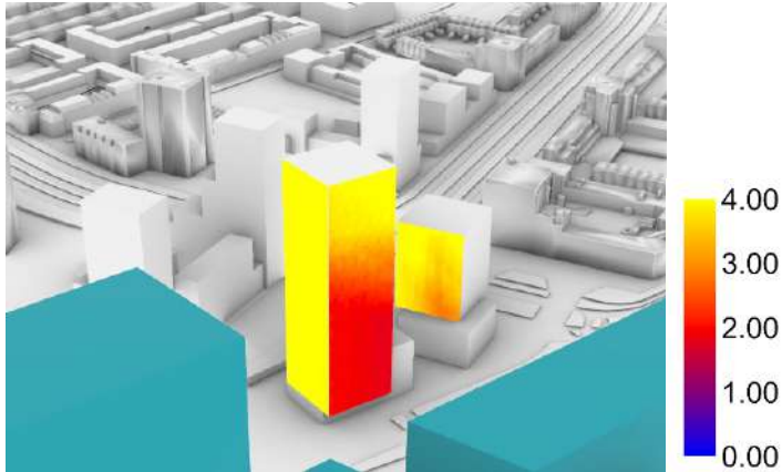
Figuur 10 Bezonning op de gevels van de torens aan de Rosestraat
