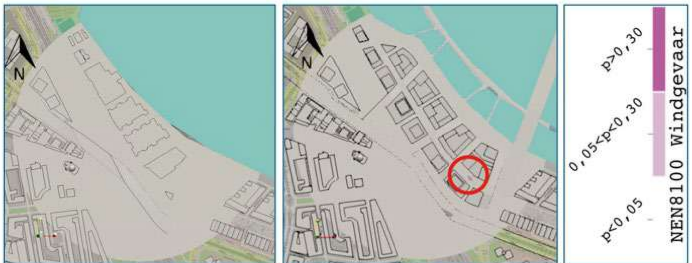
Figuur 5.12.4 Kans op windgevaar op straatniveau in de huidige (links) en nieuwe situatie (rechts) (Bron: Onderzoek Windklimaat RHDHV)
