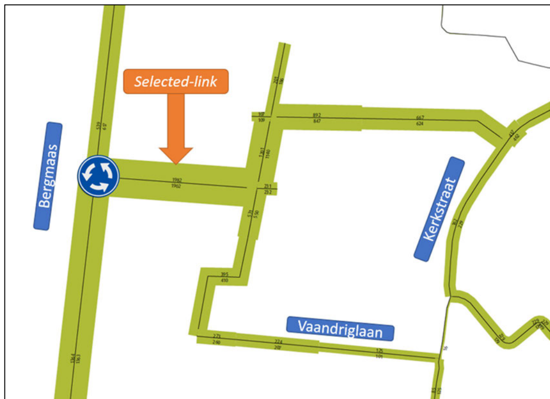
Figuur 3-2: Selected-link analyse ontsluitingsweg Repelakker III. Een selected-link analyse brengt in kaart wat de herkomst en bestemming is van het verkeer dat over een bepaalde weg rijdt.
