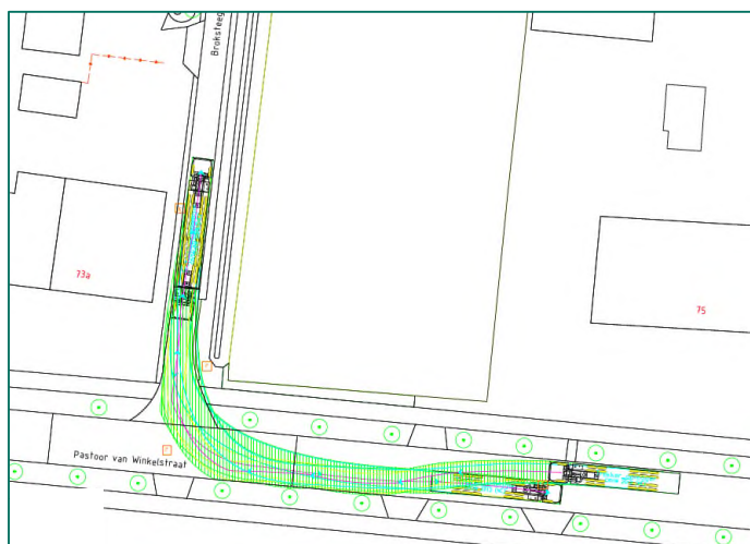
Figuur 2 Rijcurves vrachtwagen Pastoor van Winkelstraat - Broksteeg
