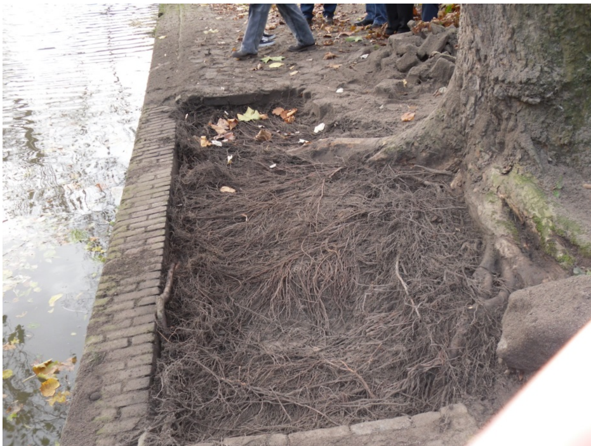
Figuur 62 – om te bepalen of een boom passeerbaar is met een renovatiemethode wordt uitgebreid wortelonderzoek gedaan
