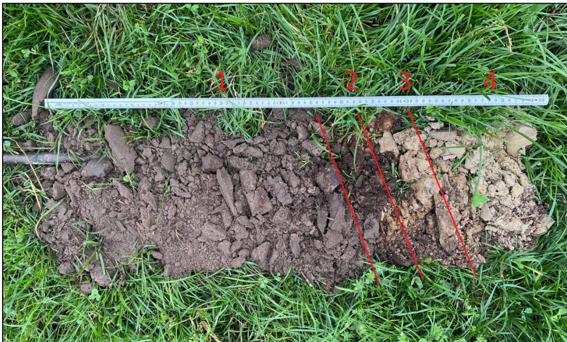
Afbeelding 15. Boorkern van boring 8, met een dun restant B-horizont. 1: bouwvoor; 2: B-horizont; 3: BC-horizont; 4: keileem
