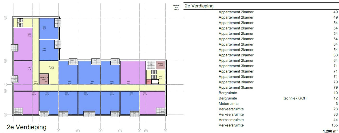
Figuur 3.3 Inrichtingstekening en programma tweede verdieping (Bron: Keeris architecten)
