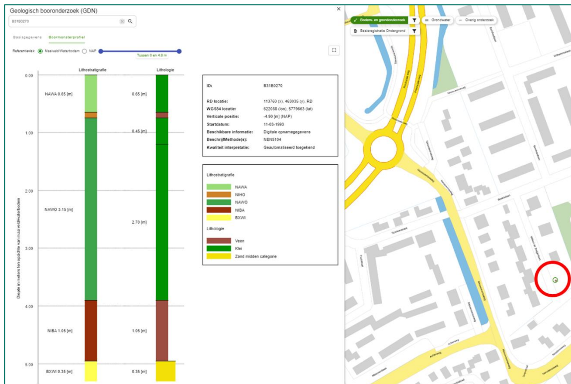
Figuur 17: Grondwatermonitorsput, Boormonsterprofiel
