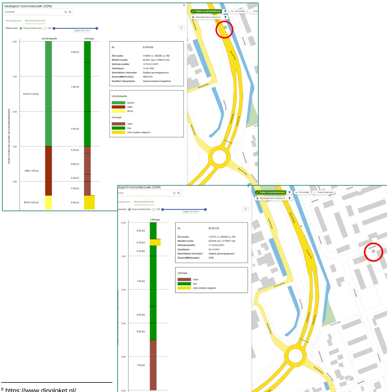
Figuur 16: Grondwatermonitoringsput, Boormonsterprofiel
