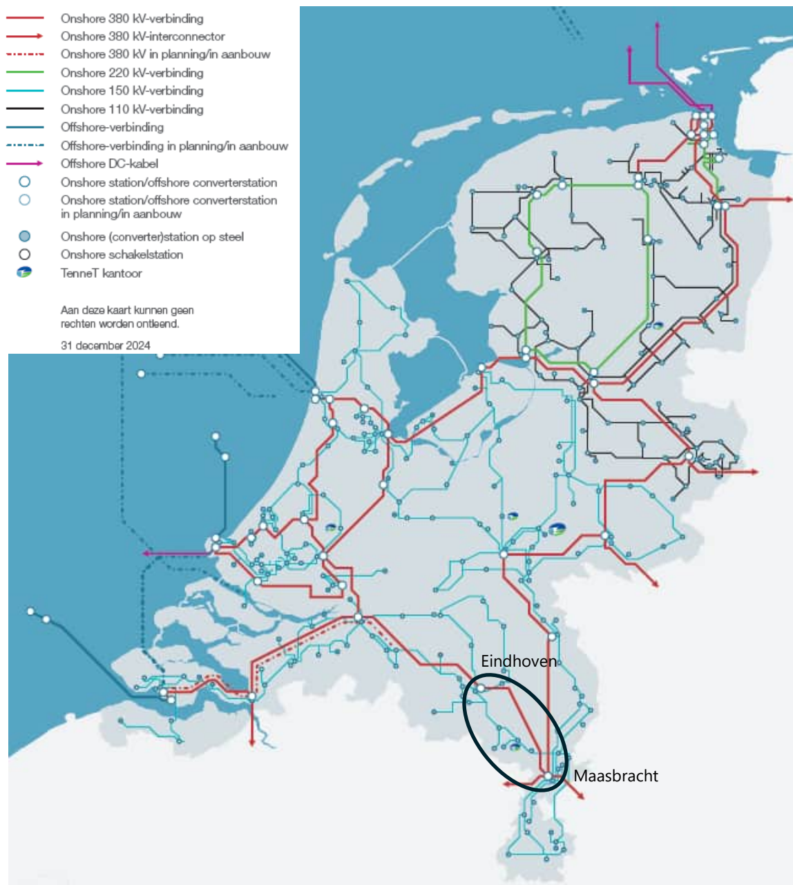
Afbeelding 2.2 Het 380- en 220 kV-net per 31-12-2024 (bron: TenneT, 2024)
