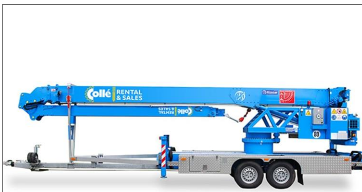
Voorbeeld van een lichte, mobiele kraan. Geschikt voor aanreiken steenstrips, glas en kozijnen.
