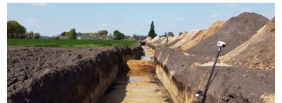
2.9 Proefsleuf breuklijnenonderzoek (sleuf 1)
