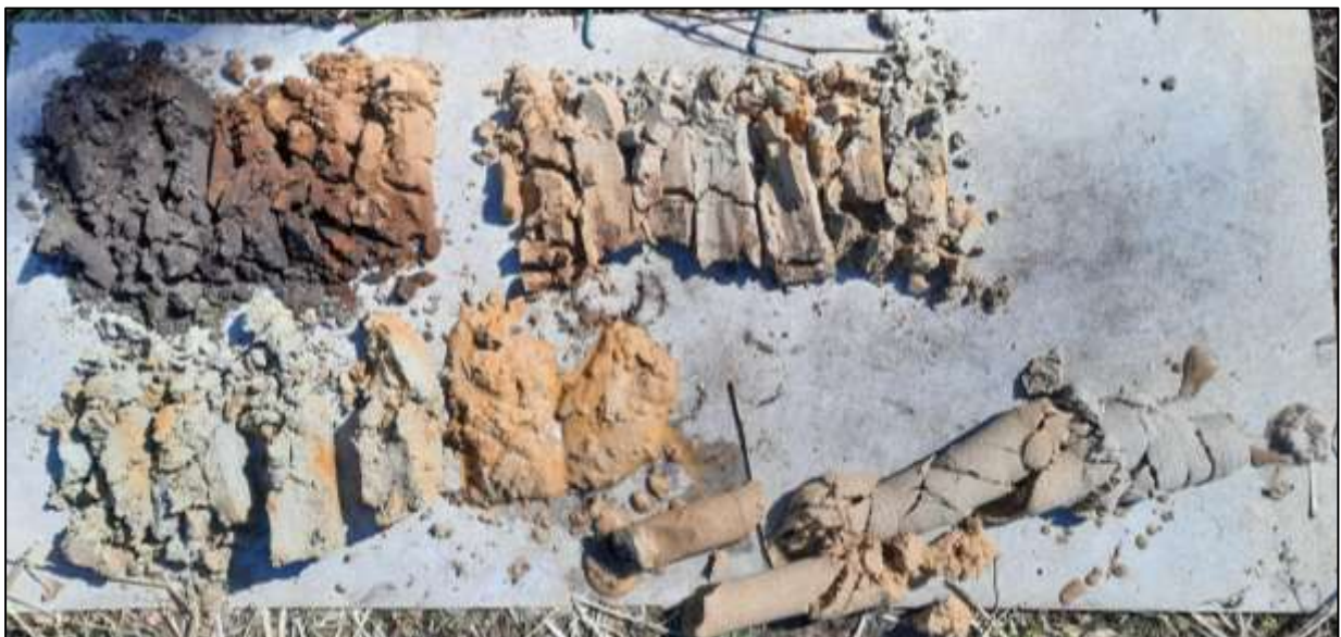
Figuur 7: Boorprofiel 2. Leesrichting van rechts naar links (0 – 250 centimeter). (Foto: 29 maart 2021).
