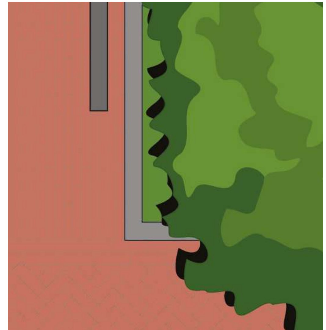
Detail OVERGANG LEGVERBANDEN EN OPSLUITBAND
