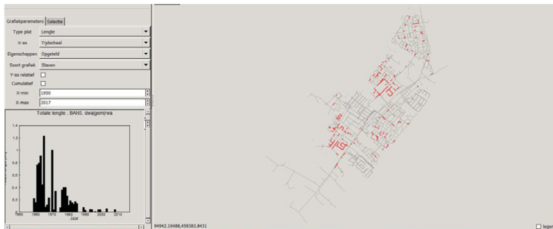
Figuur B - 28. Overzicht van rioolstrengen in gemeente Voorschoten waar het toestandsaspect poreuze buis (BAN) is aangetroffen (rood).
