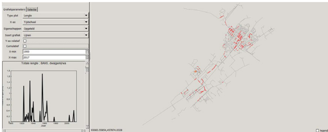
Figuur B - 19. Overzicht van rioolstrengen in gemeente Wassenaar waar het toestandsaspect poreuze buis (BAN) is aangetroffen (rood).
