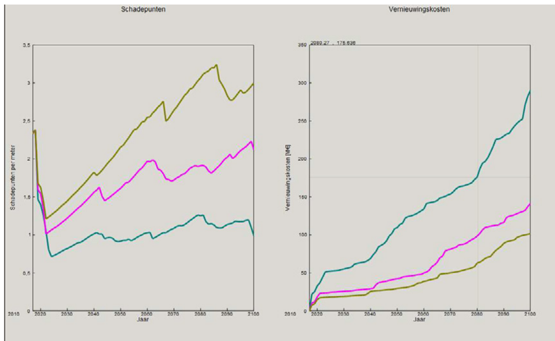
Figuur 6-1. Ontwikkeling van de kwaliteitstoestand van de riolering volgens 3 modellen. Model 1: handhaven levensduur van 80 jaar (blauw). Model 2: handhaven van huidige kwaliteit (paars). Model 3: sturen op kwaliteit en risico (bruin).
