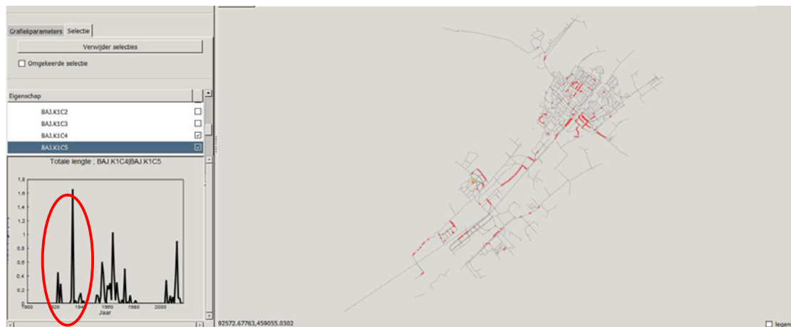
Figuur B - 21. Overzicht van rioelstrengen in gemeente Wassenaar waar hoekverdraaiing is aangetroffen (donkerblauw).
