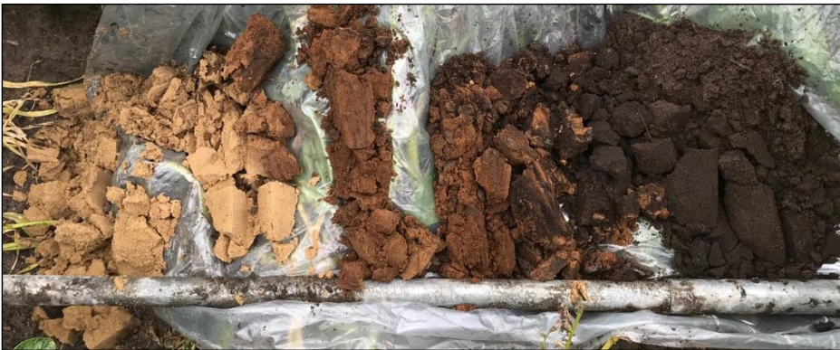
Figuur 7: Boorprofiel . Leesrichting is van rechts naar links (0-100 cm).
