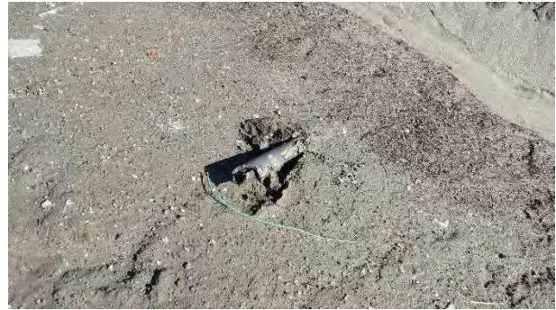
6 Afval in afdekgrond deklaag
