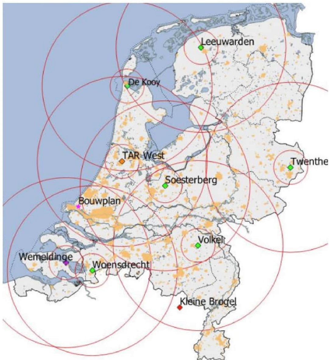
Figuur 5.33 Locaties van de zes MASS verkeersleidingsradarsystemen (groene ruit) met daaromheen de 15 en 75 kilometer cirkels. De ligging van het te toetsen bouwplan is aangegeven met een roze ster
