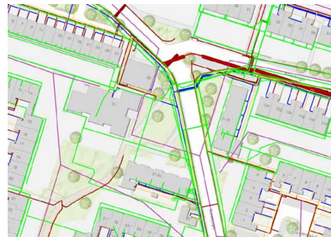
Figuur 20 - Indicatieve tracés kabels en leidingen
