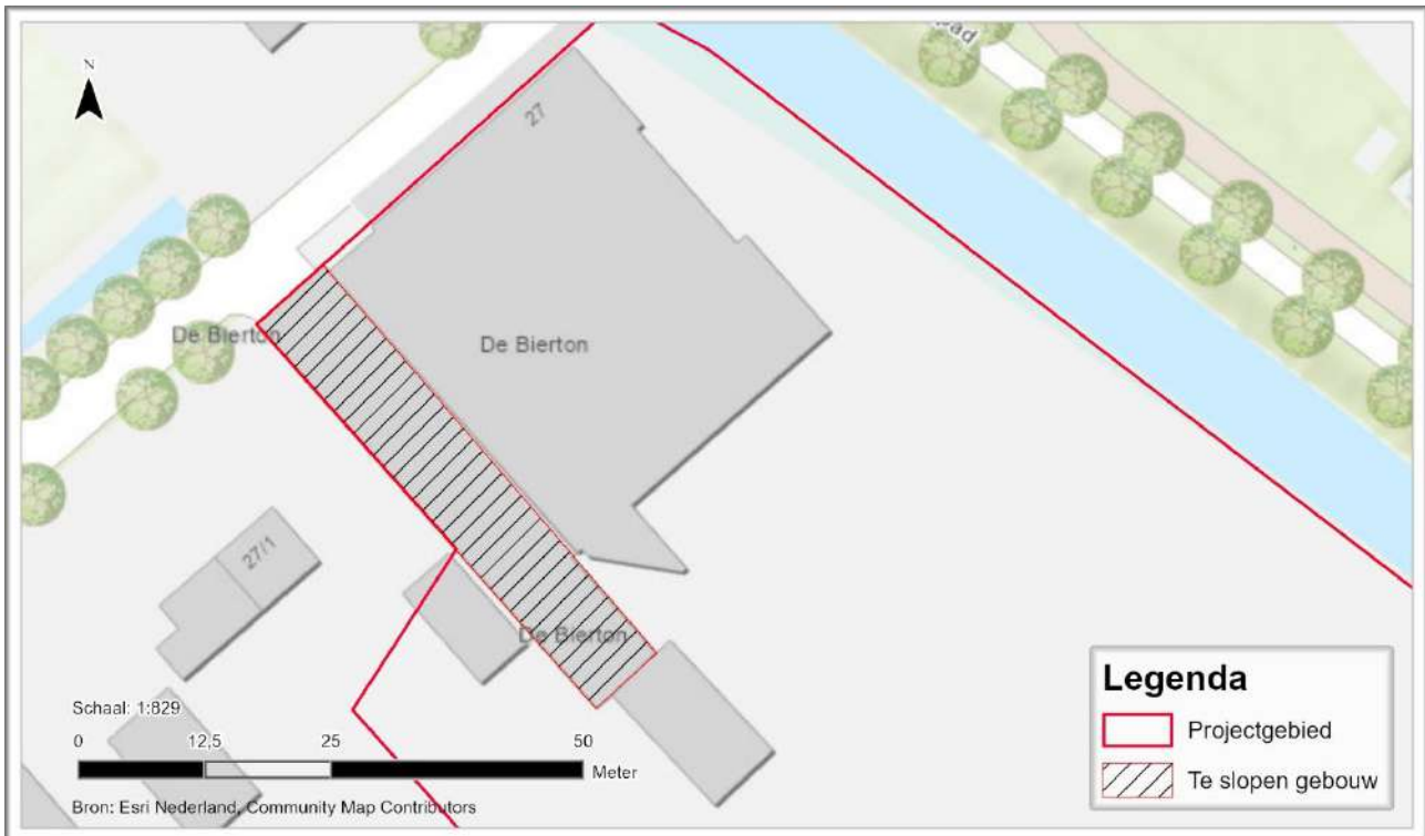
Afbeelding 1.3 Het te slopen overkapping binnen het projectgebied.
