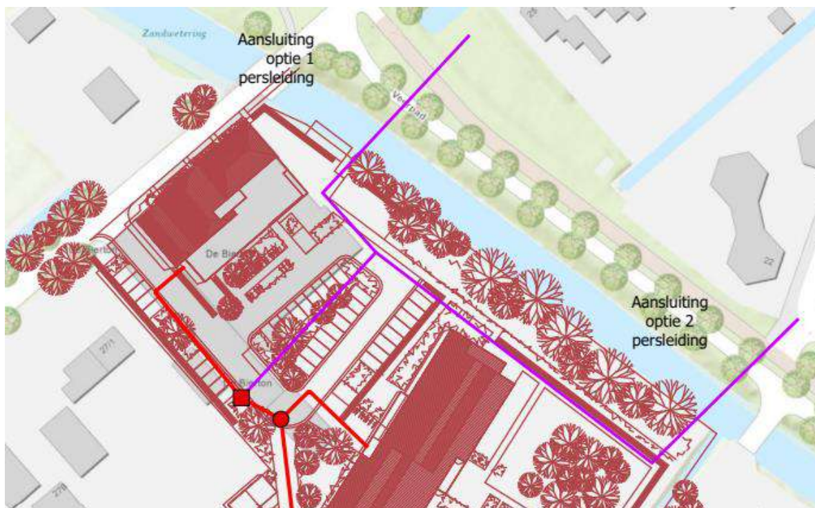
Figuur 12: mogelijke opties VWA (rood = vrij verval, paars = persleiding)
