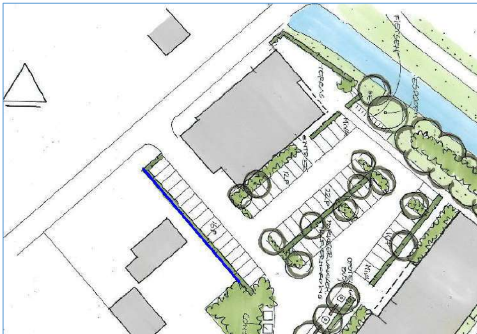
Afbeelding 2: Situering te realiseren 2,5 m hoog geluidscherm (blauwe lijn)
