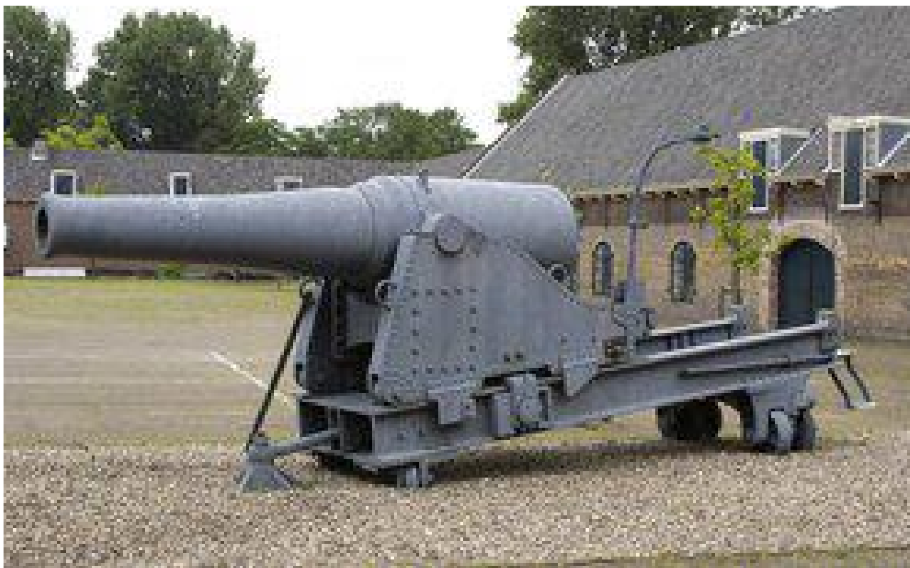
Figuur 8 - Het 24 cm kanon, zoals er een was geplaatst op bastion Groningen. Dit exemplaar komt uit de collectie van het Nationaal Militair Museum en is afkomstig van het fort Sabina, waar 19 van deze wapens waren opgesteld. De hiermee afgeschoten projectielen wogen 144 kg en konden op een afstand van 768 m een pantserplaat van 20,6 cm dikte doorboren. In 1911 werden deze kanonnen als verouderd beschouwd. De overige 18 exemplaren van Fort Sabina en ook die van Willemstad werden gesloopt (foto: Nationaal Militair Museum).
