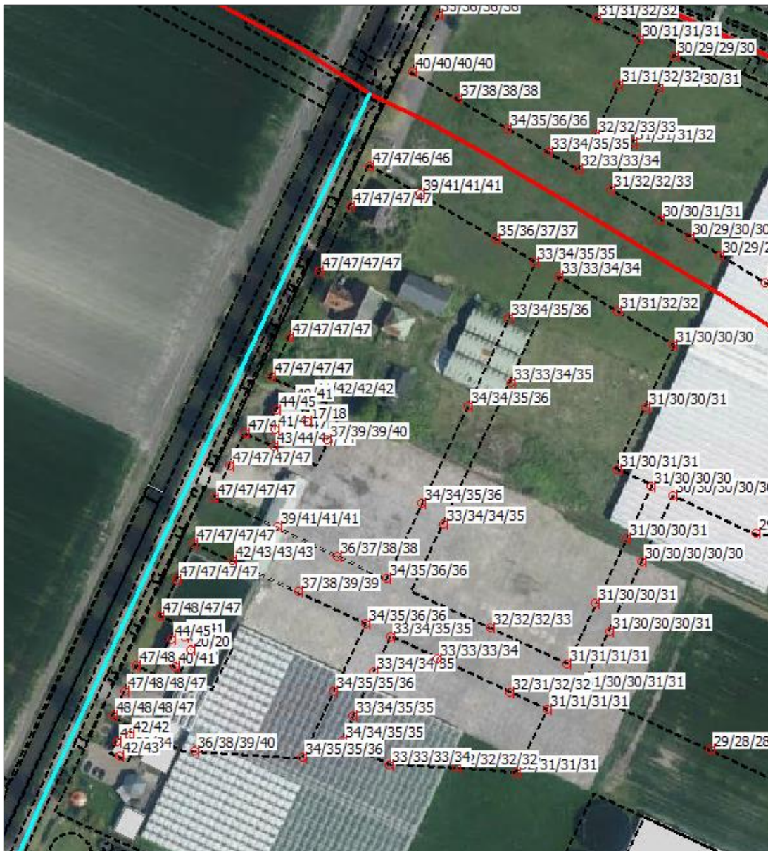
Figuur 9 Geluidbelasting vanwege de Noorddammerweg in dB inclusief correctie. Dit betreft de hoogst berekende geluidbelasting per toetspunt.
