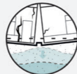
Verzakking door grondwaterontrekking
