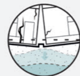
Verzakking door grondwaterontrekking
