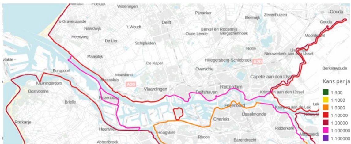
Figuur 5.1 Normspecificatie voor primaire waterkeringen, uitgedrukt in een overstromingskans per dijktraject
