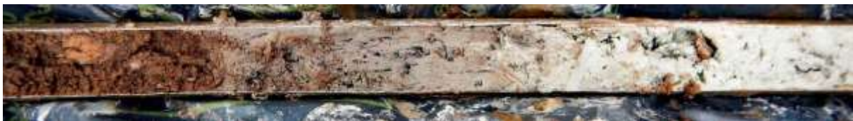
Figuur 18: Boring 2 detail met houtskooldeeltjes in de vegetatielaag (centraal) pal onder het veen (links) tussen 235 en 245 cm -mv.
