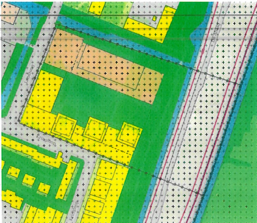
Afbeelding 1: Uitsnede ontwerp en 50 kV-kabelverbindingen (roze lijnen)
