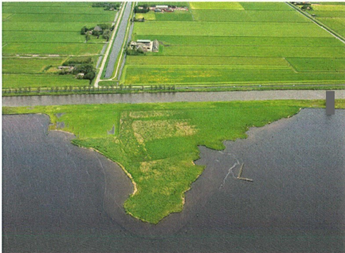
figuur 5: foto afkalving achter beschoeiing
