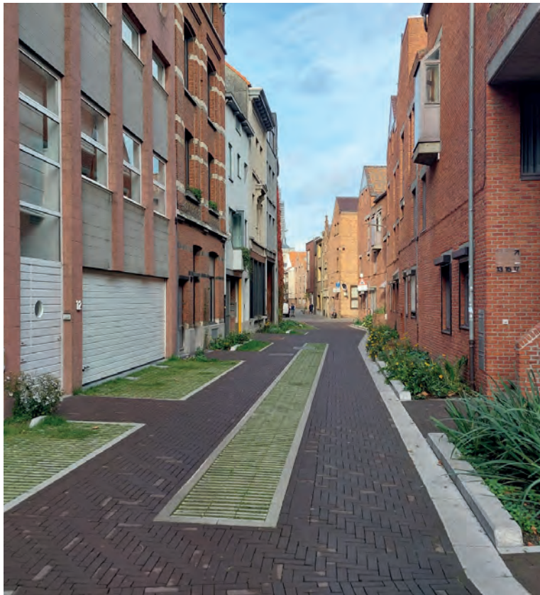
Een voorbeeld van een hedendaagse erfinrichting in Antwerpen, waarbij ook klimaatadaptieve maatregelen zijn genomen, zoals groenvakken, half-open verhardingen en ondergrondse waterbuffers.
