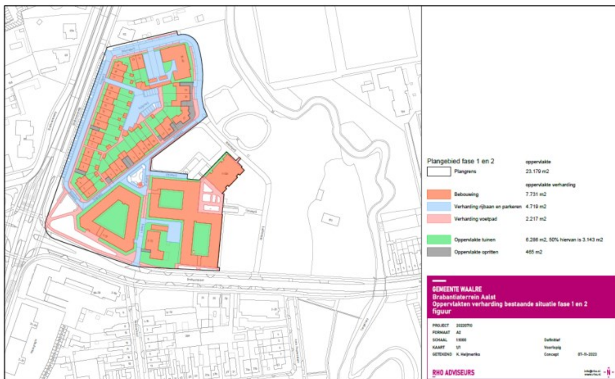
Figuur 5.2 Verharde oppervlakten fase 1 en fase 2
