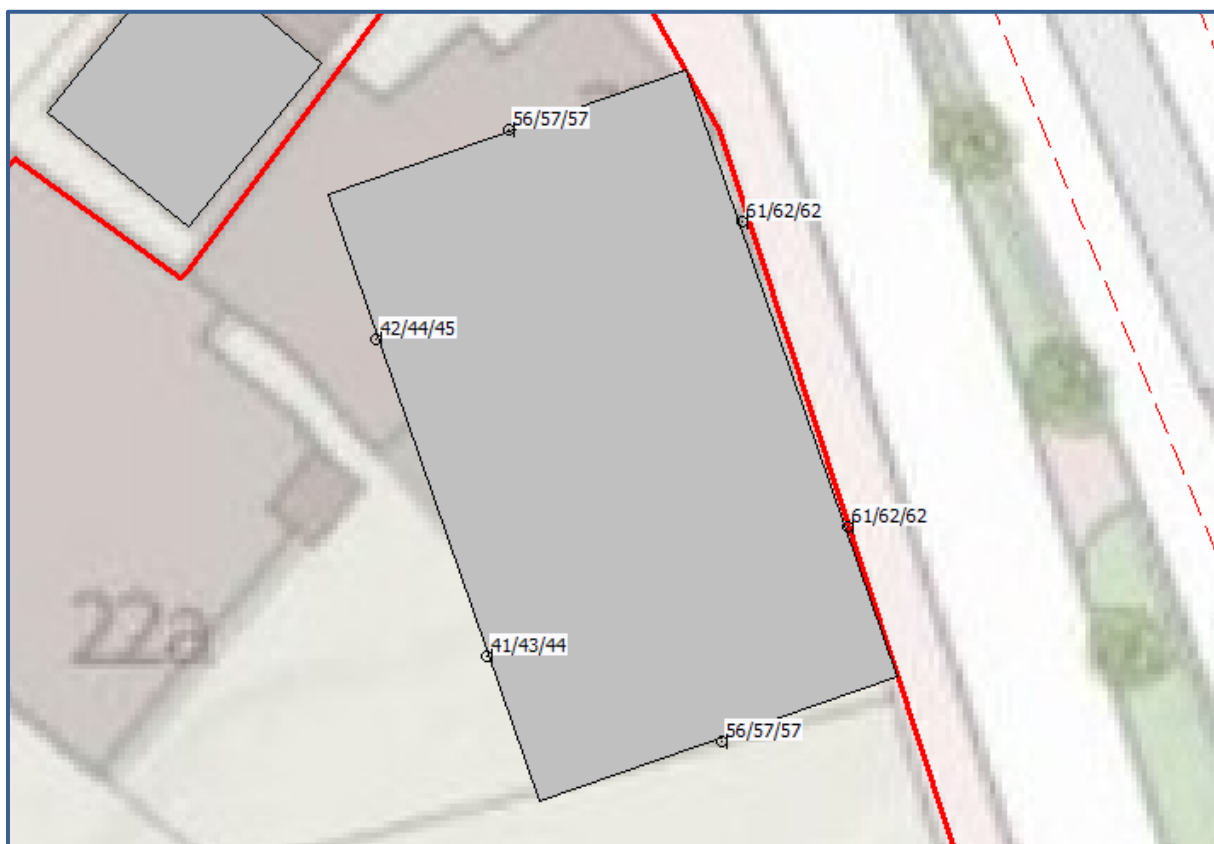
Afbeelding 6. Geluidbelastingen Lden (excl. aftrek art. 110g Wgh) cumulatief Berekende geluidbelastingen op een hoogte van 1,5 / 4,5 / 7,5 meter
